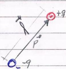
$\vec{p}$  es el vector que se genera en la línea de acción de la carga negativa a la positiva, y se define como momento dipolar eléctrico.
